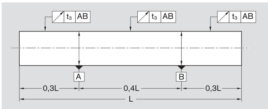
Измерение круглости. Схема позволяет сравнить круглость трубчатого вала и прецизионного стального вала.
