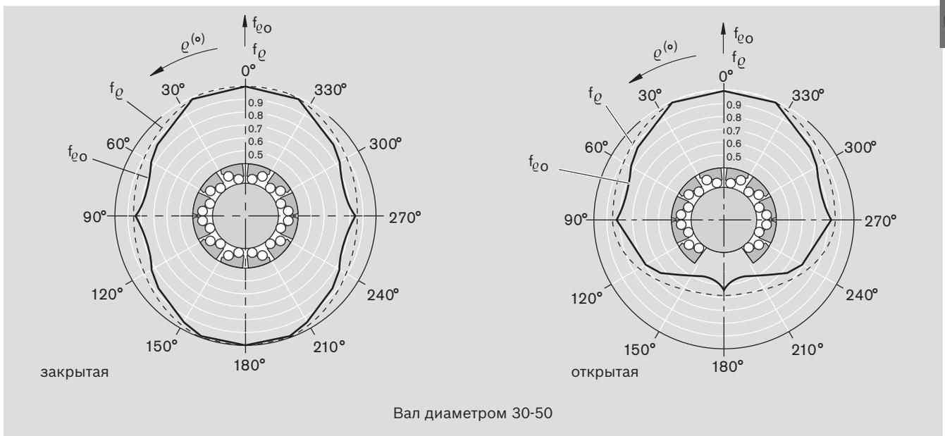
Шариковые втулки «Супер» устанавливаются в любом монтажном положении. Монтажное положение нужно выбрать так, чтобы основное направление нагрузки всегда соответствовало  $\rho = 0^\circ$ .
