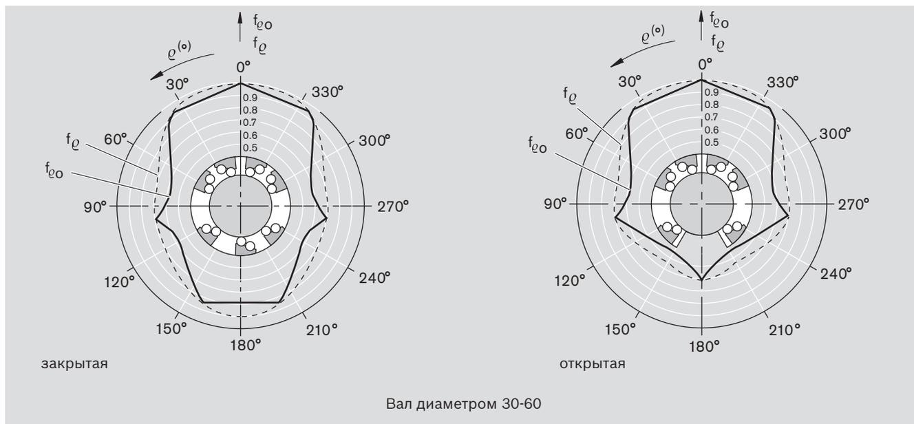
Шариковые втулки «Супер» устанавливаются в любом монтажном положении.
