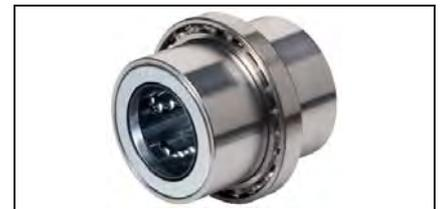
**Линейные устройства** - это готовые подшипниковые узлы, состоящие из одной или нескольких шариковых втулок Rexroth в едином корпусе. Они поставляются в различных исполнениях. Благодаря рациональной технологии изготовления линейные устройства являются экономически более выгодным решением, чем конструкции, собранные по индивидуальному заказу. Корпус легко выравнивается при монтаже и препятствует тем самым перекосу шариковых втулок.
