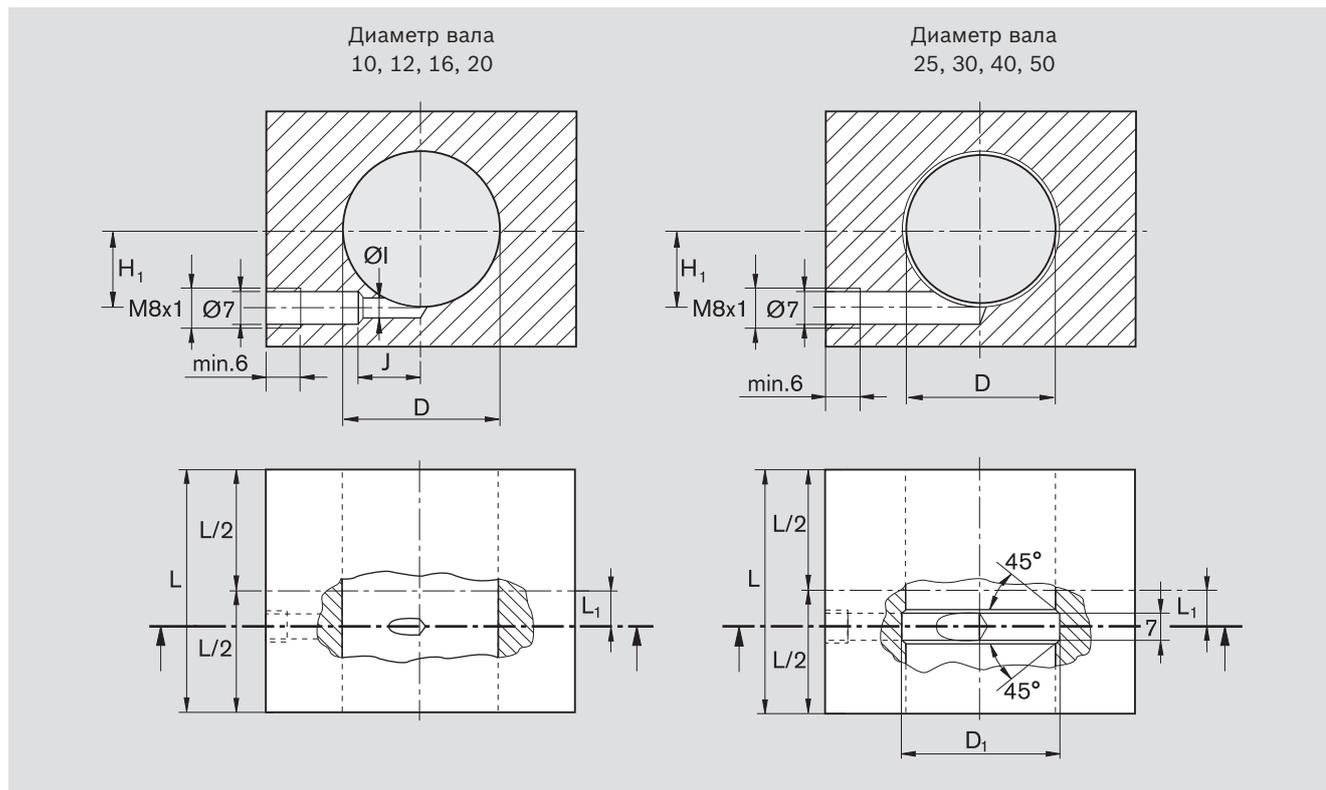
Показанные на рисунке смазочные каналы рассчитаны на использование пластичной смазки, см. раздел «Указание» на стр. <OV>.
