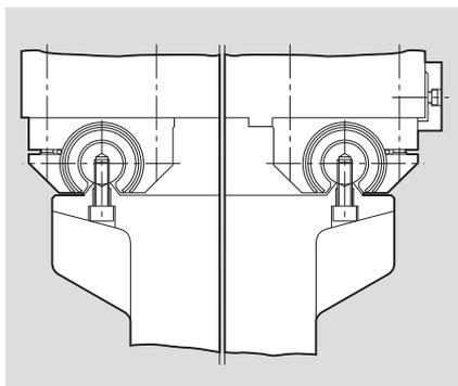
Опорные рейки соединены со станиной станка (небольшая конструктивная высота)
