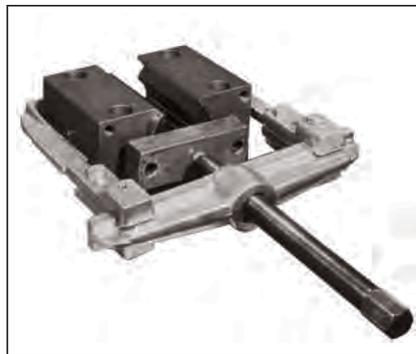
В качестве альтернативы для запрессовки предварительно смонтированной радиальной шариковой втулки можно использовать съемник. Толкатель в штанге должен быть закреплен с помощью шарикоподшипников (стрелка). В противном случае, установить осевой подшипник перед толкающей штангой во избежание проворачивания радиальной шариковой втулки в корпусе под действием возникающих крутящих моментов.
