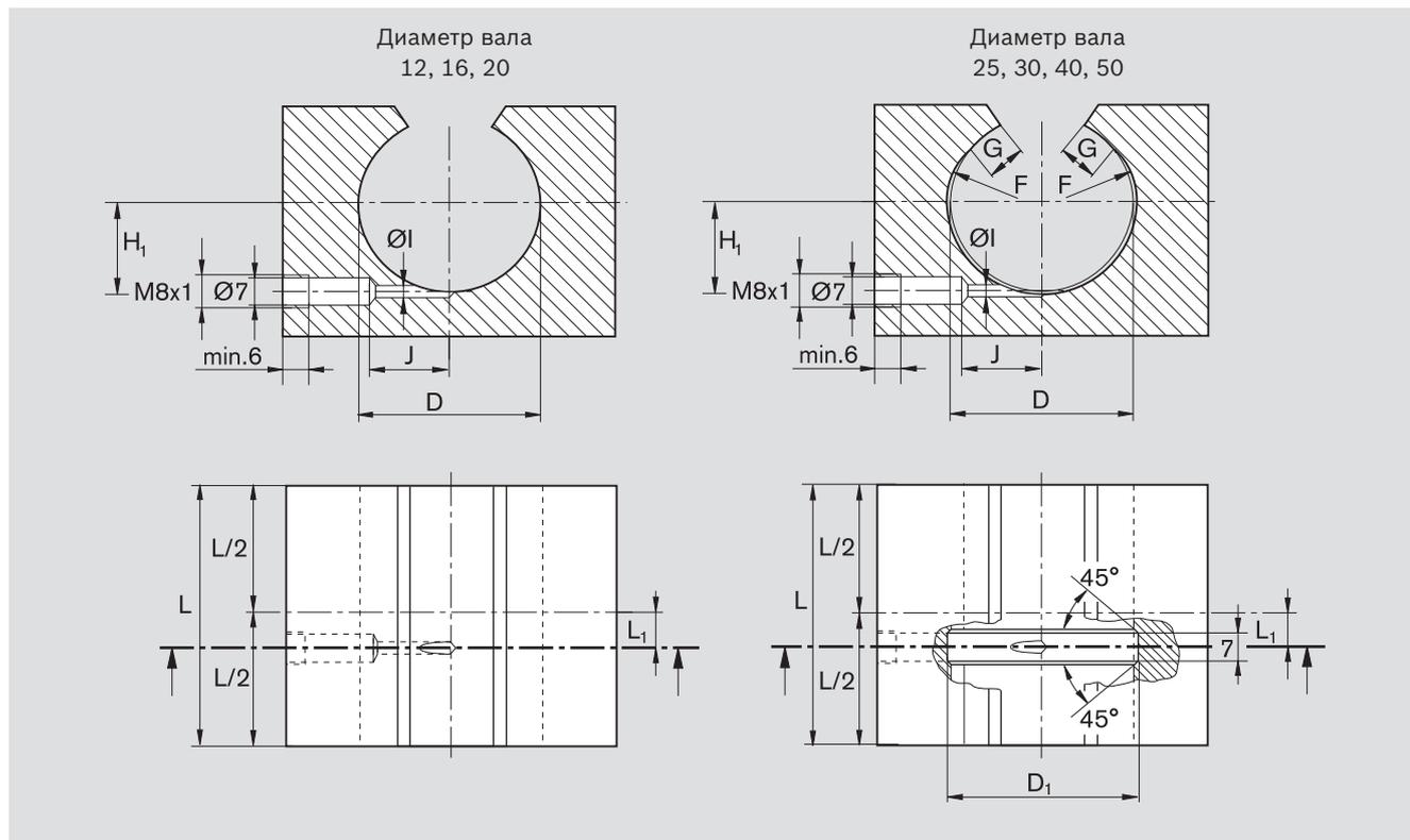
Показанные на рисунке смазочные каналы рассчитаны на использование пластичной смазки, см. раздел «Указание» на стр. <OV>. Защитить уплотнительные кольца от осевого смещения.
