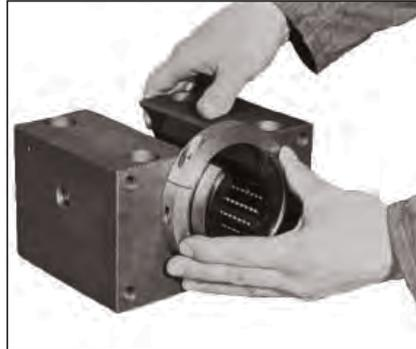
в отсутствии следов масла на внешней стороне радиальной шариковой втулки и в отверстии корпуса.
