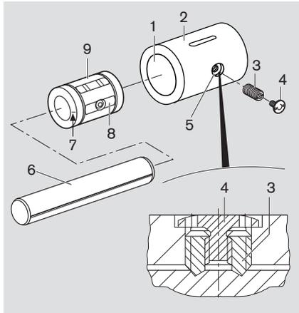
**⚠** Готовые линейные устройства в сборе с выставленным минимальным зазором. После извлечения вала необходимо ослабить установочные винты и заново отрегулировать моментную шариковую втулку.
