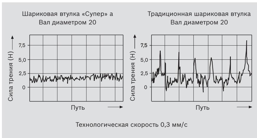
Для компенсации несоосности как минимум один вал направляющей должен быть оснащен двумя шариковыми втулками «Супер».
