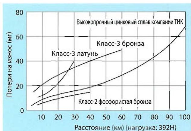
Рис1 Износостойкость высокопрочного цинкового сплава
