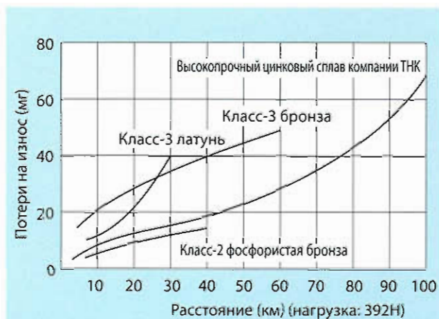
Рис2 Износостойкость высокопрочного цинкового сплава
