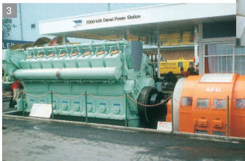
3. Acoplamiento de bridas MMG 25000 entre un motor Diesel y un alternador. Potencia eléctrica de salida: 7.000 kVA.
