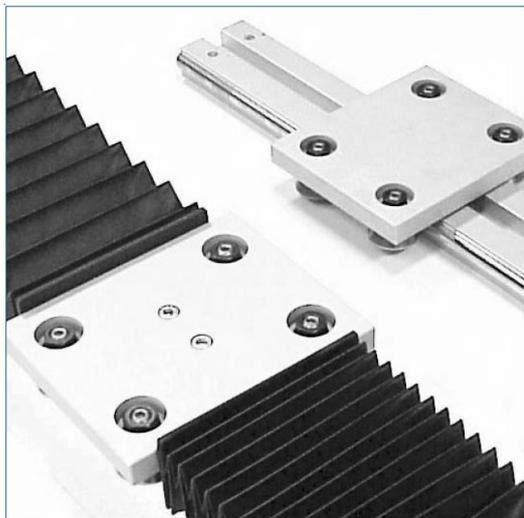
Le système linéaire **GD** permet de réaliser des mouvements linéaires avec des solutions de montages simples, économiquement et techniquement avantageux. Le galet de roulement sur les arbres de précision est réglable en fonction de l'application, ce qui permet au système des mouvements doux en cas de vitesse élevée et de faible charge ou une grande rigidité en cas de charge élevée.
