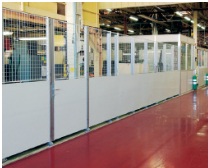
Axelent FlexiStore plast och plåtvägg på Renault Cléons anläggning i Frankrike.
