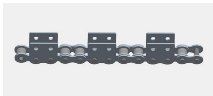
Kette mit K2 Winkel einseitig an jedem 2. Außenglied Roller chain with attachment K2 every other outer link on one side
