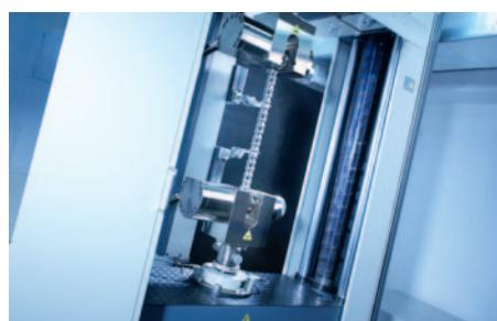
Bruchkraftermittlung und Dehnungsaufnahmen bis 1000kN
