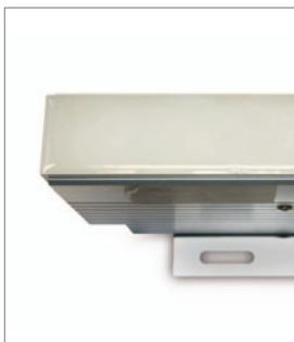
Luminaria completamente resinada, que ofrece un grado de protección IP66/68, un grado de impacto IK10 y soporta una presión sobre la luminaria de 30kN. Pisable y transitable. No apto para vías rápidas.
