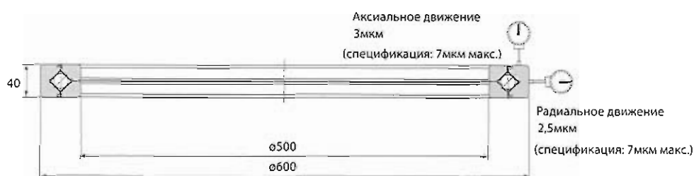
Точность вращения наружного кольца модели RE50040CC0USP
