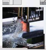
Поверхностная закалка Наиболее интересна при увеличенном профиле, как при и больших длинах. Только требуемая часть поверхности прокаливается.
