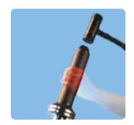
В случае с разборными подшипниками внутреннее кольцо может устанавливаться независимо от наружного кольца, что упрощает процедуру монтажа, особенно когда оба кольца имеют посадку с натягом. При установке вала с уже установленным на нем внутренним кольцом в корпус с наружным кольцом необходимо внимательно следить за отсутствием перекоса колец, возникновение которого может вызвать задиры на дорожках и телах качения.
