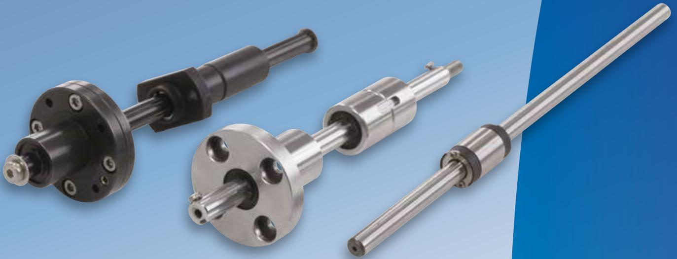
Les arbres à couple résistant sont constitués d'un axe et d'une douille à billes disposant de quatre rainures. Les chemins de roulement sont trempés par induction et ont une dureté superficielle de 60HRc. L'avantage de cette solution est de pouvoir supporter des charges et des couples multidirectionnels tout en conservant une très grande précision.
