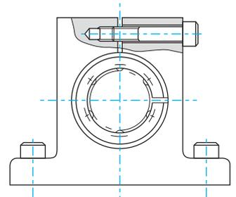
Montage avec douilles ouvertes
