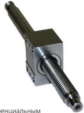
Натяг создан и зафиксирован дифференциальным зубчатым зацеплением гаек с корпусом.
