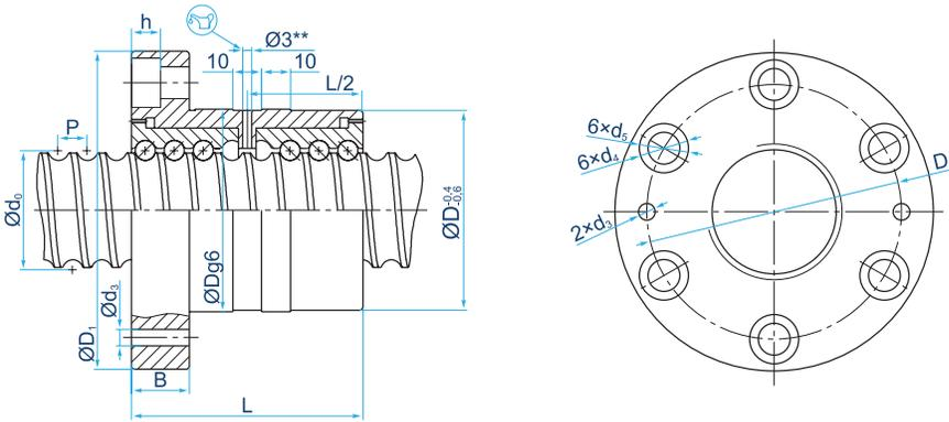
Натяг создан и зафиксирован дифференциальным зубчатым зацеплением гаек с корпусом.
