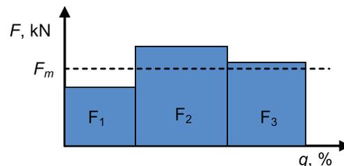
Для передач с двойными гайками, собранными с предварительным натягом, эквивалентная динамическая нагрузка  $F_m$  рассчитывается для каждой гайки отдельно, с учетом силы натяга  $F_{pr}$
