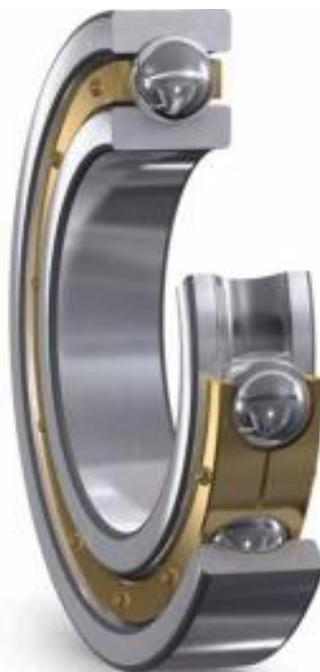
Подшипники тяговых электродвигателей обычно оснащаются неразъемным или разъемным механически обработанным латунным сепаратором. В некоторых случаях SKF поставляет цилиндрические роликоподшипники, оснащенные полиэфирэфиркетонным (PEEK) сепаратором.
