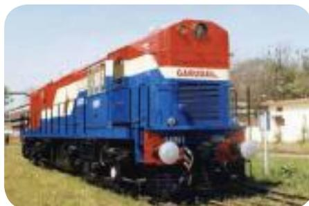
Индийский грузовой тепловоз с электрической передачей WDG-2A, max. скорость 100 км/ч, тяговый дв. пр-ва BHEL, полная мощность 3 100 HP / 2 300 кВт, в эксплуатации с 1995.
