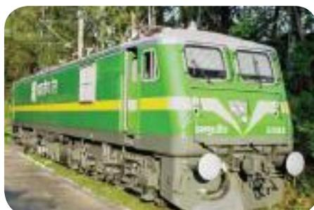
Индийский 3-фазный грузовой электровоз WAG-9, max. скорость 100 км/ч, тяговый дв. пр-ва ABB, мощность 6 000 л.с. / 4474 кВт, в эксплуатации с 1996.
