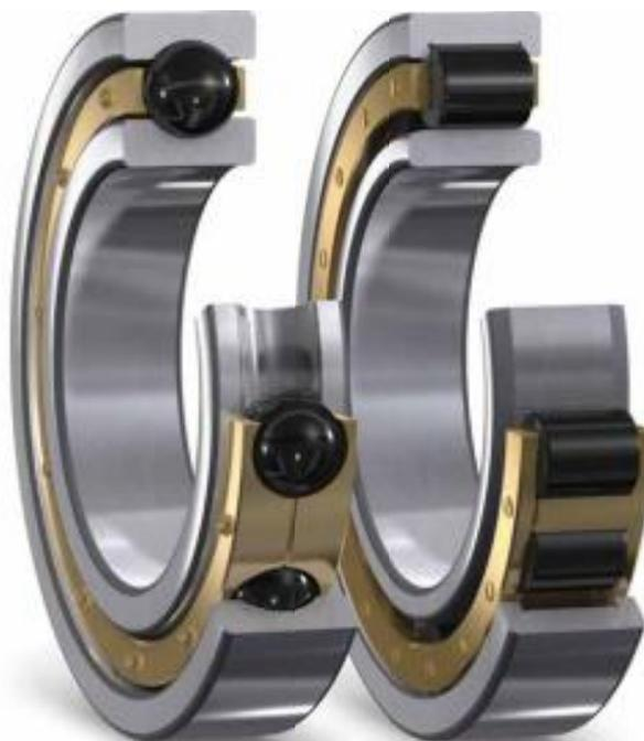
Гибридные подшипники обеспечивают дальнейшее улучшение электроизоляционных свойств, особенно для современных областей применения высокочастотных инверторных систем. Эти подшипники оснащаются телами качения, изготовленными из нитрида кремния.
