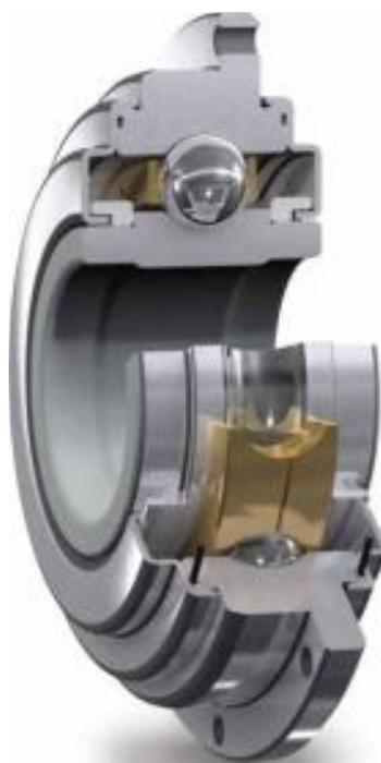
Электроизоляция может быть обеспечена путем применения гибридной конструкции на керамических шариках или нанесением электроизолирующего покрытия INSOCOAT на монтажную поверхность отверстия внутреннего кольца.
