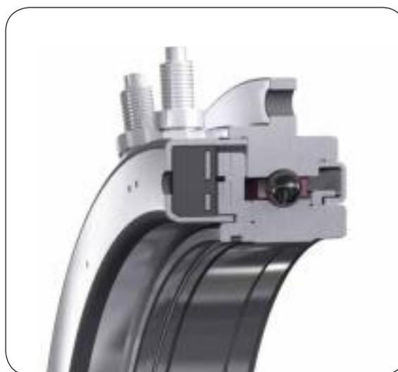
Концепция подшипникового узла ТМВU с датчиком обеспечивает ряд возможностей по детектированию и измерению:
