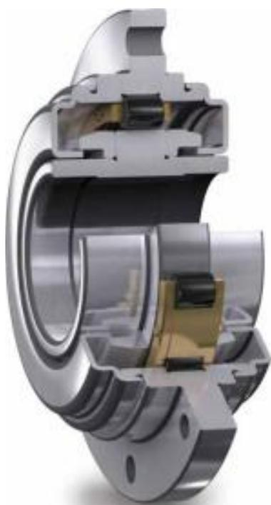
Конструкция подшипникового узла тягового двигателя ТМВU для плавающей опоры основывается на применении цилиндрического роликоподшипника. Этот герметичный подшипниковый узел с заложенной пластичной смазкой имеет встроенный фланец на наружном кольце для крепления на болтах к щиту тягового двигателя.
