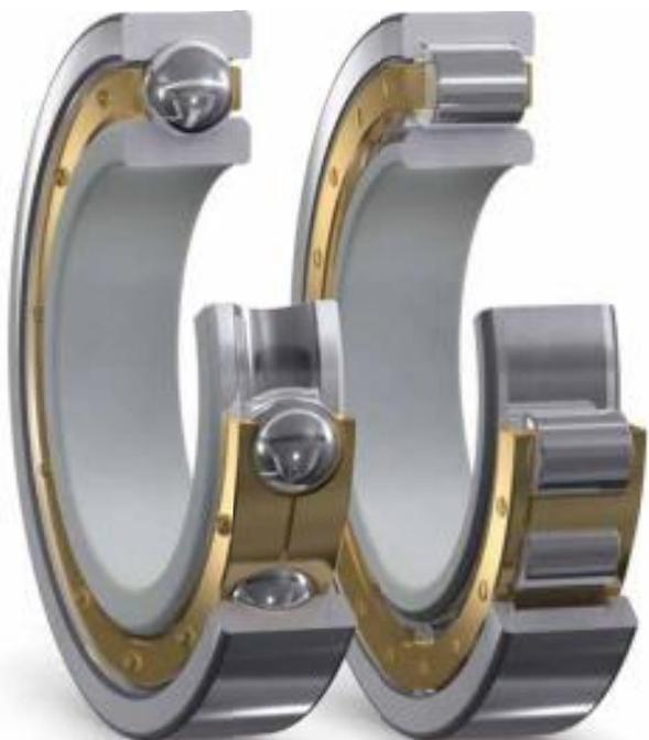
Конструктивный принцип изоляции внутреннего кольца обеспечивает улучшенные изоляционные характеристики, особенно для больших тяговых электродвигателей. Покрытие из оксида алюминия наносится на монтажные поверхности внутреннего кольца: отверстие, фаски и торцы.
