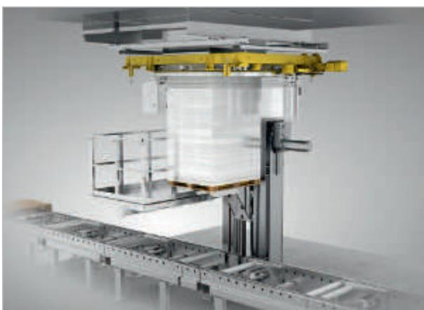
Die Fördertechnik transportiert die gestreckte Palette ab. Die nächste Palette wird bereitgestellt. Optional kann der An- und Abtransport der Paletten auch manuell erfolgen. Die Wechselzeit zwischen zwei Ladungsträgern beträgt lediglich wenige Sekunden.
