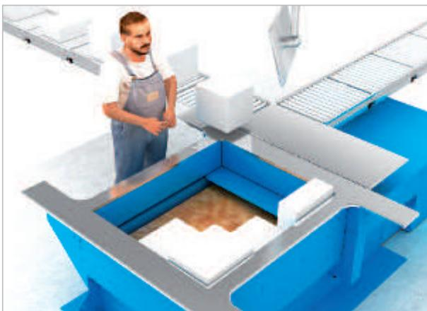
Ist die Palette fertig kommissioniert, wird sie automatisch über den Schacht abgesenkt. Die Schachtwände sorgen dafür, dass die Ladung stabil bleibt. Das ist besonders bei Paletten mit gemischten Waren wichtig. Ein Wickelstretcher umhüllt die Ladung sofort automatisch mit einer Folie, sobald die Palette den Schacht verlässt. So sind die Waren für den Transport vor Verrutschen und Verunreinigungen geschützt.
