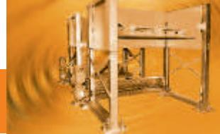
Eine Palette wird auf dem Kommissioniertisch der FAST PICK STATION mit unterschiedlichen Waren beladen. Diese werden einzeln oder auf Trays angedient, das Waren-Wirtschafts-System sorgt für die richtige Reihenfolge. Der Kommissionierer kann die Höhe der Palette immer individuell anpassen.
