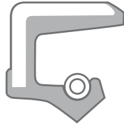
One lip with spring Un labio, con resorte
