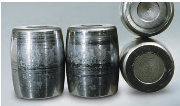
Фото 2.3 Деталь: Сферические ролики с фото 2.1 Симптом: Характерное выкрашивание круглой формы по центру поверхности роликов Причина: Недостаточная смазка
