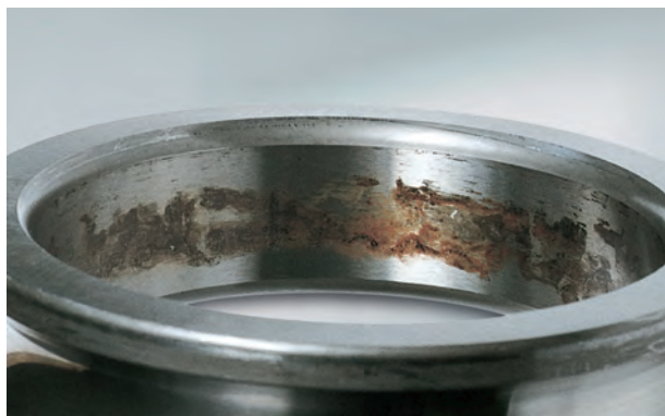
Фото 11.1 Деталь: Внутреннее кольцо радиального шарикового подшипника Симптом: Истирание на поверхности отверстия Причина: Вибрации
