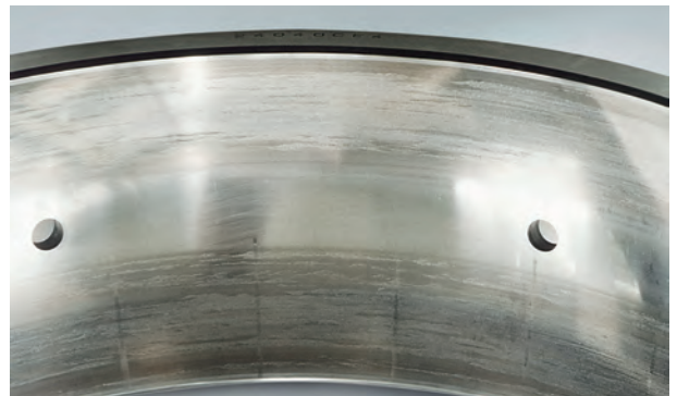
Фото 4.4 Деталь: Наружное кольцо с фото 4.3 Симптом: Размазывание по периферии поверхности следов вращения Причина: Недостаточная смазка
