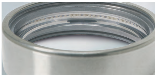
Фото 15.6 Деталь: Наружнее кольцо шарикового подшипника Симптом: Рефление на поверхности следов вращения (Высокой частоты)
