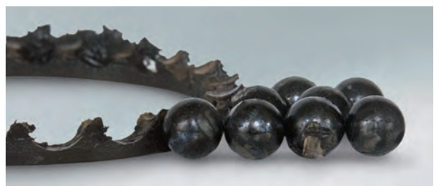
Фото 14.5 Деталь: Шарики и сепаратор с фото 14.3 Симптом: Сепаратор оплавился, шарики изменили цвет и оплавнились Причина: Чрезмерный предварительный натяг
