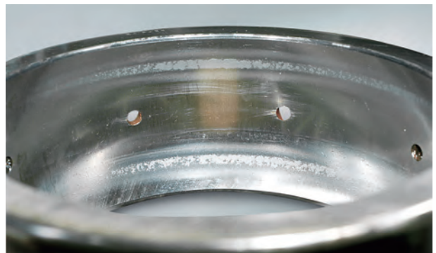
Фото 2.4 Деталь: Наружное кольцо подшипника качения со сферическими роликами Симптом: Выкрашивание вблизи буртика следов вращения по всей периферии Причина: Недостаточная смазка
