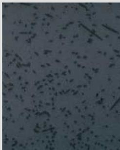
Сухой термopластичный подшипниковый материал с гомогенными добавками, полученный путем впрыскивания
