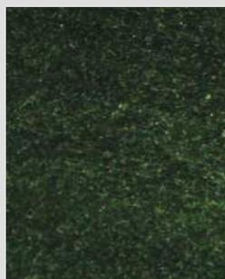
Сухой термопластичный подшипниковый материал с однородными добавками, полученный путем впрыскивания
