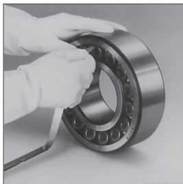
Рис. 1. Проверка зазора подшипника на верстаке.
