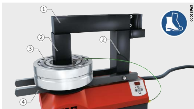
Рисунок 22 Подшипник качения, уложенный горизонтально
